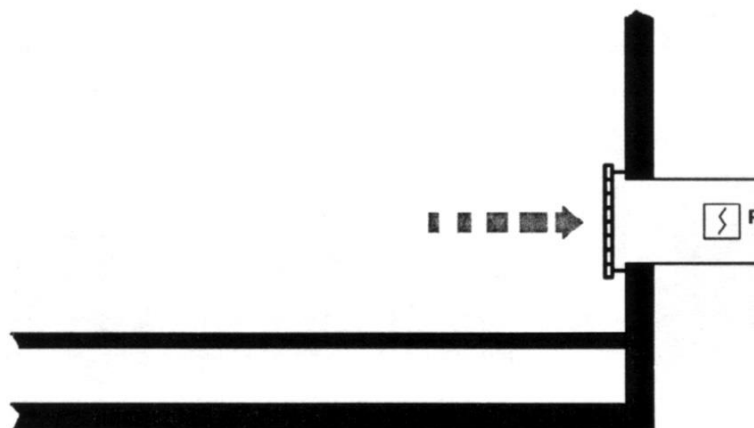
Слика Отвори за извлачење ваздуха близу пода: Заједно са детекторима на плафону, надгледање извлачења ваздуха се препоручује са АСД детекторском јединицом
