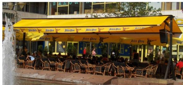
Тенда је слободностојећа монтажна конструкција са покретним застором који се приликом затварања намотава или склапа, служи за заштиту од сунца и других атмосферских прилика, а на површину јавне намене се ослања својим деловима. Поставља се искључиво на простору летње баште осим пешачке зоне Неготина зони (Трг Стевана Мокрањца и Трг Ђорђа Станојевића) где није дозвољено постављање тенди.
