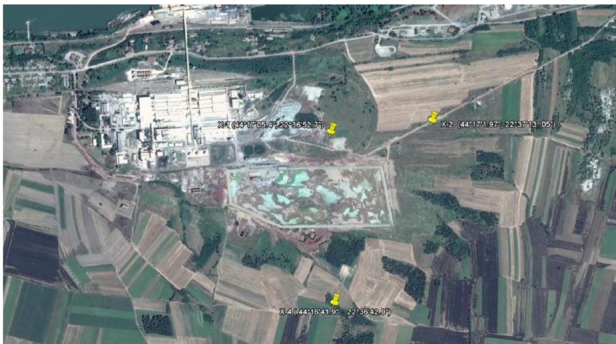
37 Karta terena sa ucrtanim lokacijama pijezometara i uzorkovanja zemljišta i podzemnih voda
