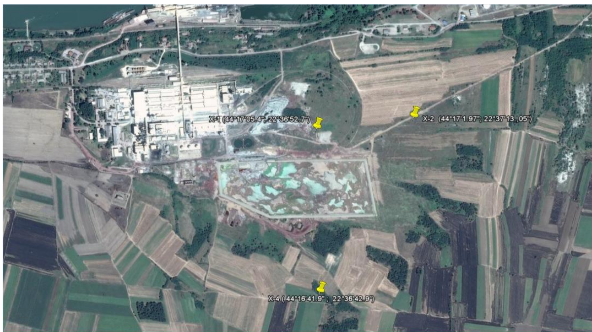
Sl.36 Položaj pijezometara na lokaciji novog skladišta fosfogipsa, postavljenih u cilju praćenja uticaja na podzemne vode:
